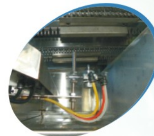
● 噴霧系統： 日本ST-6噴頭，日本SMC無杆氣缸驅動及SMC氣管經久耐用。
