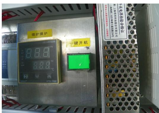
锡炉双温度控制保护，相位保护，一键式启动
