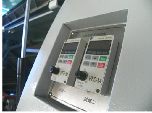
变频器控制锡炉高度，可从 **0-15MM** 可调，满足不同产品焊接要求（非长脚作业）。
