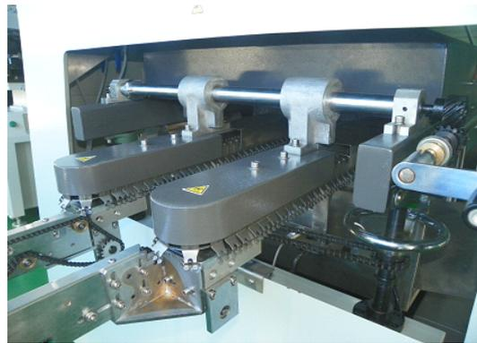
导轨调宽系统：采用蜗轮传动，三点式自动调宽系统，防止热变形，保证高精度运行可靠。
