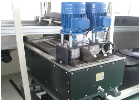
锡炉采用铸铁发热板外热式加热，炉胆使用超厚无铅专用材料制作，高强度防腐处理，炉体结构设计保护装置，永不变形。锡炉自动升降进出机构，便于维修保养（可选）。
