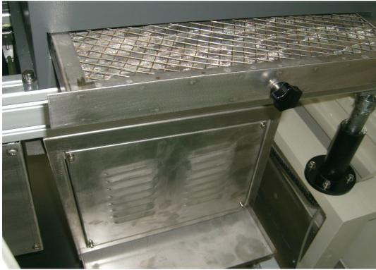
内置助焊剂废气回收系统：该系统采用滤网集中收滤方式，使用模组化设计的多层金属网，可快速更换，亦可重复使用，且保养容易，有效延长炉膛清洁周期，符合 ISO14001 标准。
