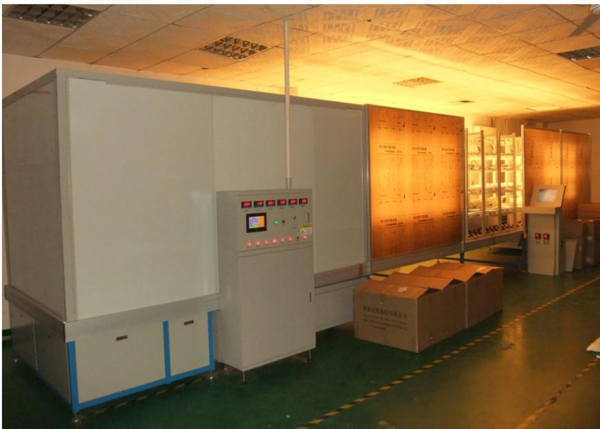
BT-1810A 型多功能 LED 灯具老化线
